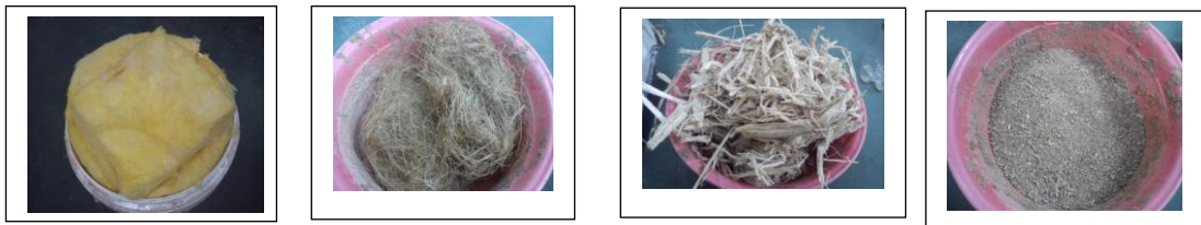
Rajah 3: Bahan pengujian, gentian kaca, sabut kelapa, hampas tebu dan hampas sagu
